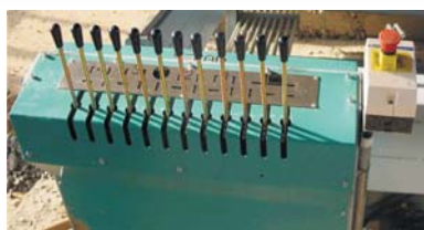
Пульт управления гидроагрегатами
