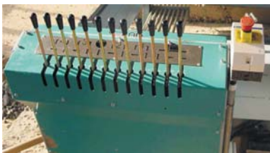
Пульт управления гидроагрегатами
